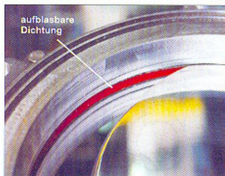
**Bild 6:** Aufblasbare Dichtung im Gegenflansch-Dichtring für hohe Anforderungen
